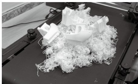
【写真1 定着不良によるモジャモジャ】
