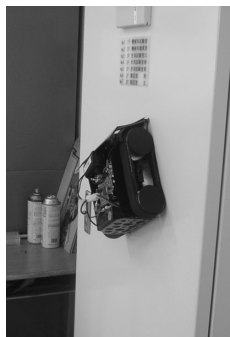
写 7 相撲ロボット壁面走行中
