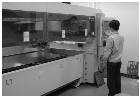
写13 レーザー加工機（電車外装切断中）
