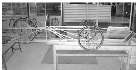
写 1 アルミフレーム製作
