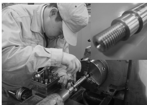
旋盤のねじ切り作業
