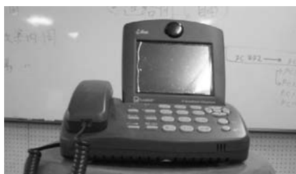
図2 IP電話（i-See）上位の黒いキャップがカメラ、背面にA/Vの入出力端子がある
