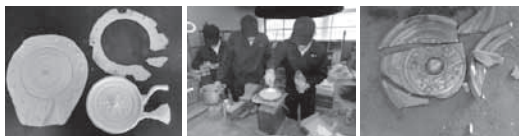
シリコン製凹型と樹脂型 金属の配合調整 もろく破碎した青銅鏡
