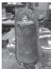
厚みを3mmから2mmにする必要があるが、青銅が回りきらなかったり、大きくひびが入るなどの失敗が続いた。やはり、薄く作るのは難しい。
