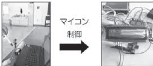
図3 CO 発生と危険値の測定・危険値の表示
