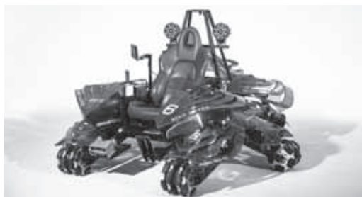
写真1 全方位移動型 6 輪プラグイン・ハイブリッドカー「ヘキサローラー」
