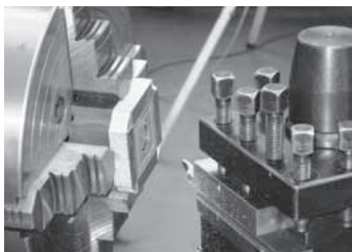
図9 刃物台を45度に傾けて加工
