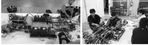
写真4 針金によるボデー形状製作の様子
