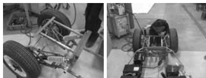
写真3 トレーリング・アームの製作
