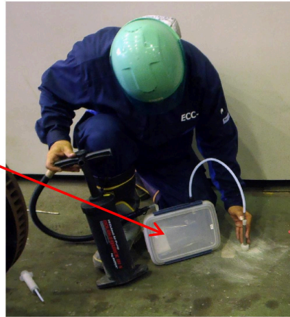
孔を密栓し、一定時間（30分以上）放置後、 捕集バッグ法により、土壌中のガスを専用 のバッグに吸引採取。
