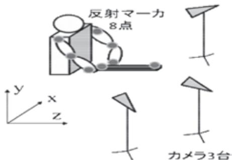
図2 計測実験図
