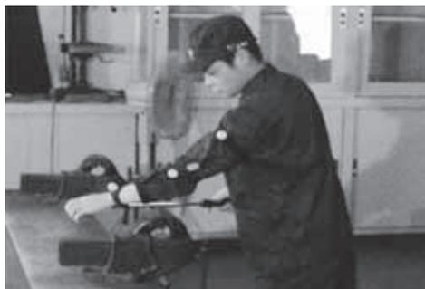
写真1 モーションキャプチャでの計測実験
