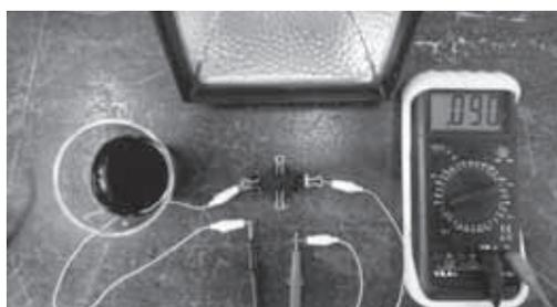
図1 色素増感太陽電池の発電例
