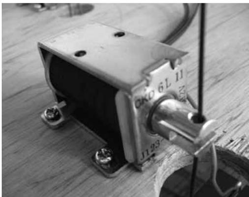
いる。今回、ソレノイドを動かすのに12Vのリレーを用いた。リレー駆動回路は、簡単なトランジスタを用いたスイッチング回路である。
