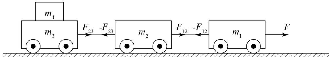
列車の加速度を  $a$  とし、各車両の運動方程式を立てると次のようになる。
