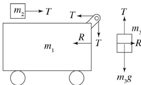
この図にもとづいて、台車と2つの物体について運動方程式を立てると次のようになる。物体 A の水平方向の加速度と物体 B の鉛直方向の加速度は等しいので、それを  $a_2$  する。
