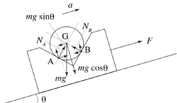
円柱の質量を  $m$ 、接触点 A と B における反力を  $N_A$ ,  $N_B$  とする。ダランベールの原理から、V ブロックとともに運動する座標系で次のような力のつり合いが成り立つ。
