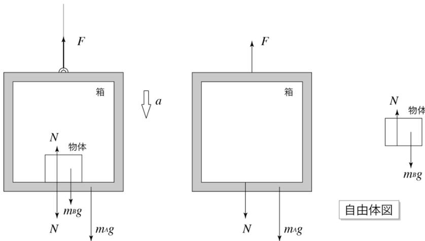
図 落下する箱とその内部に置かれた物体
