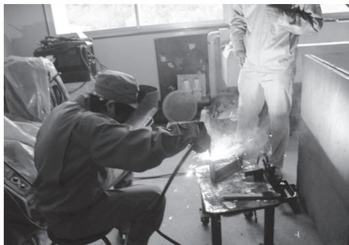
写真3 カートの部品の製作
