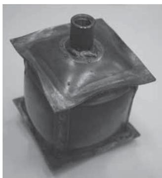
写真4 圧力試験後の圧力容器
