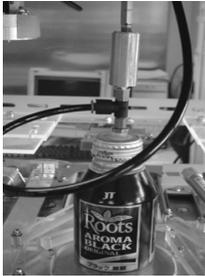
写真14 キャップの吸引(左)・ボトル飲料降下(右)
