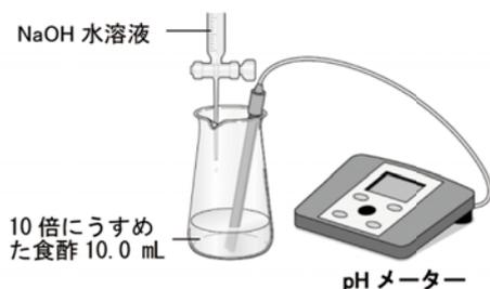
NaOH 水溶液を滴定量の2倍になるまで0.5 mL ずつ加えて pH を測定する(③で求めた中和点の前後0.5 mL の間は0.1 mL ずつ加える)
